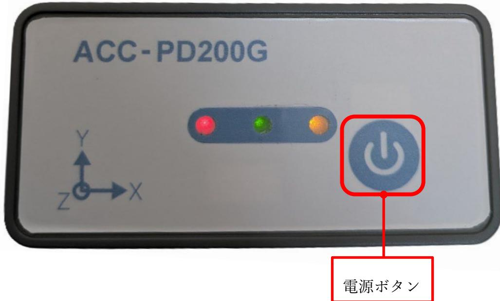
電源ボタンを3秒長押しすると起動（オレンジが点滅）してBLEコネクト待ち（アドバタイズ）の状態（黄緑の点滅）になります。
